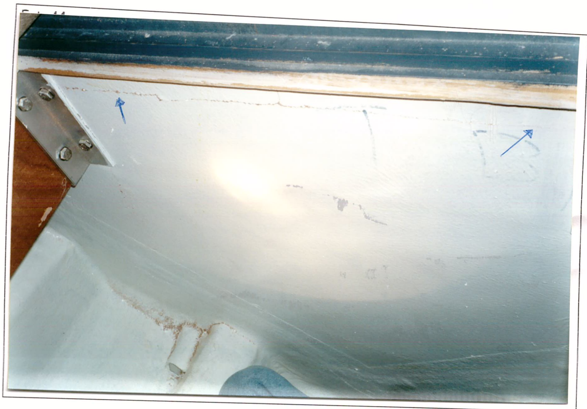
Antepara entre cabines - Rachaduras diversas e serragem. Bulkhead between cabins - Cracks and wood dust.
