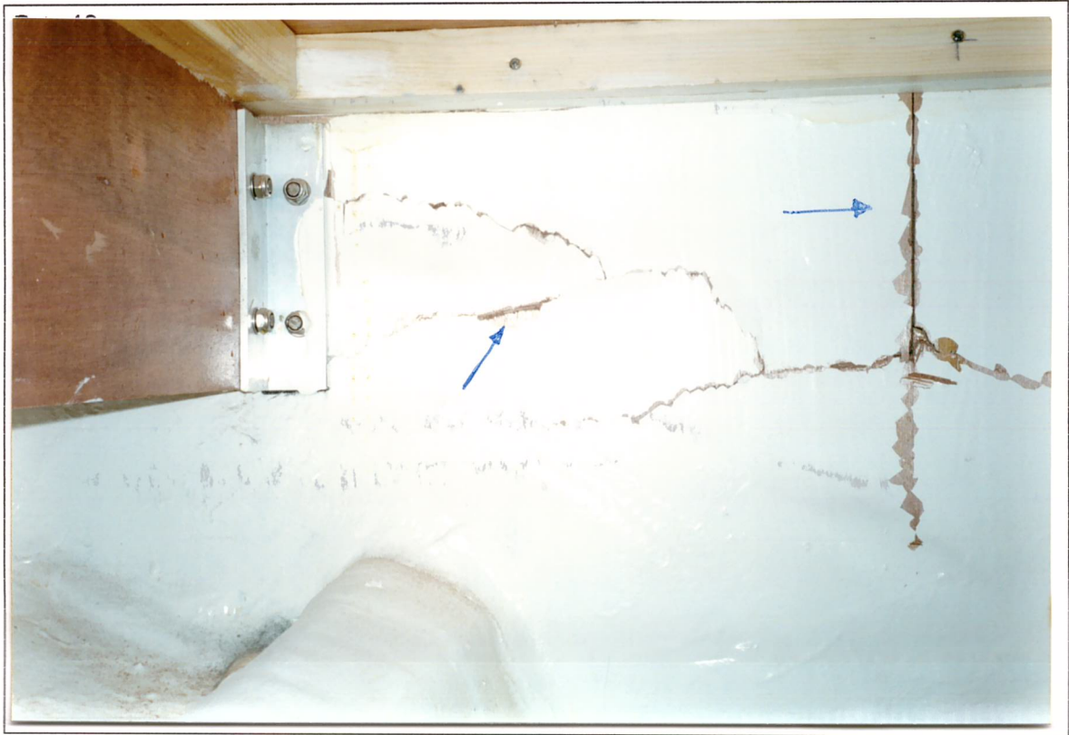
Antepara principal sob a cabine master - Notar ruptura por compressão. Main bulkhead below master cabin - See compression rupture.
