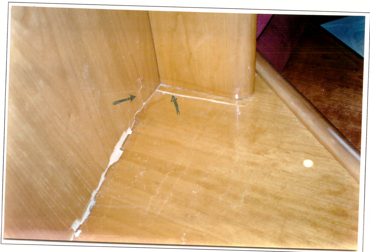
Antepara da cabine master - Rachaduras na folha de revestimento, no criado mudo, e na antepara principal, por trás do revestimento. Main cabin bulkhead - cracks in the veneer, in the side table and in the main bulkhead behind the veneer.
