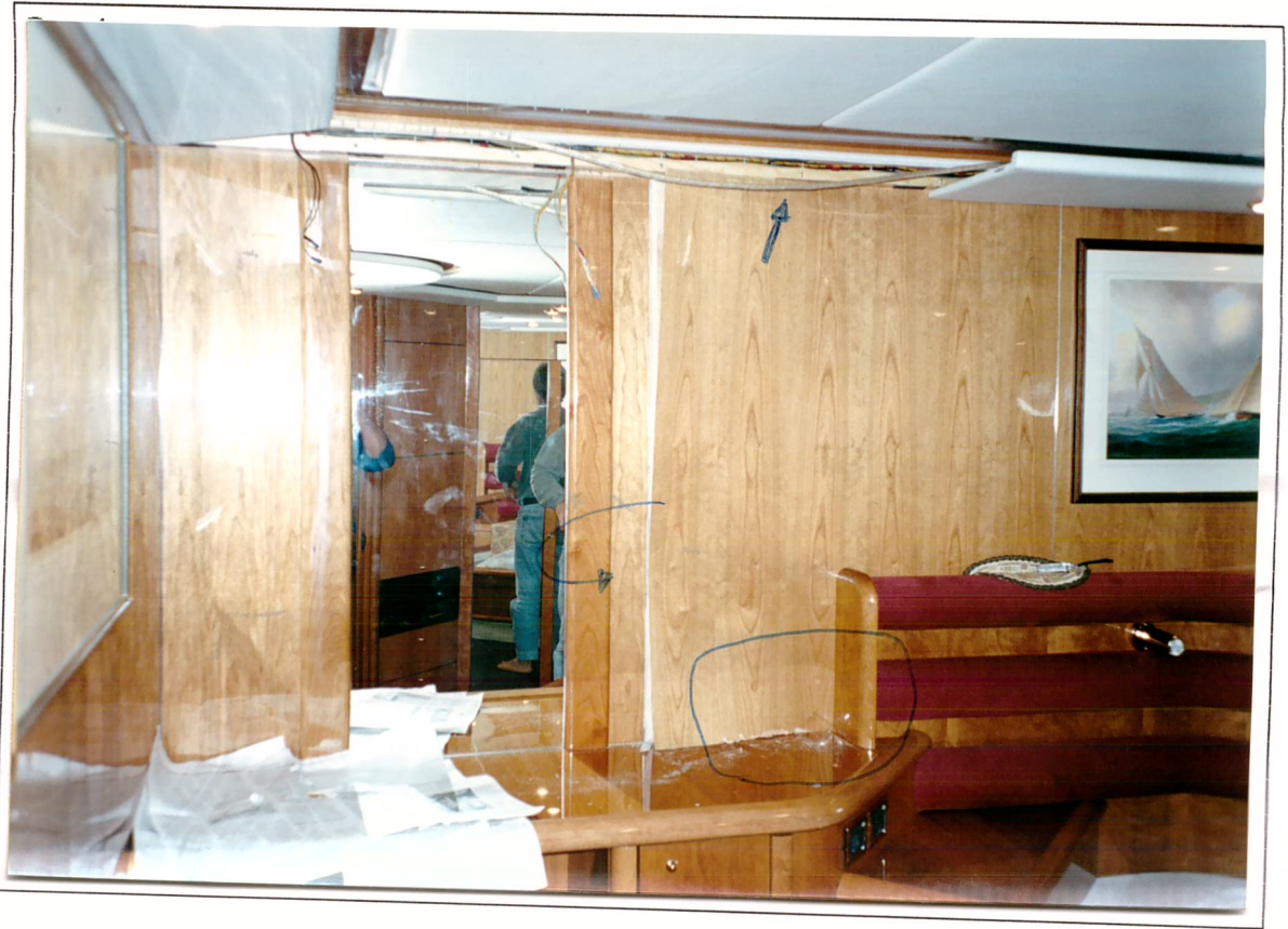
Antepara da cabine master - Rachaduras na folha de revestimento, no criado mudo, e na antepara principal, por trás do revestimento. Main cabin bulkhead - cracks in the veneer, in the side table and in the main bulkhead behind the veneer.
