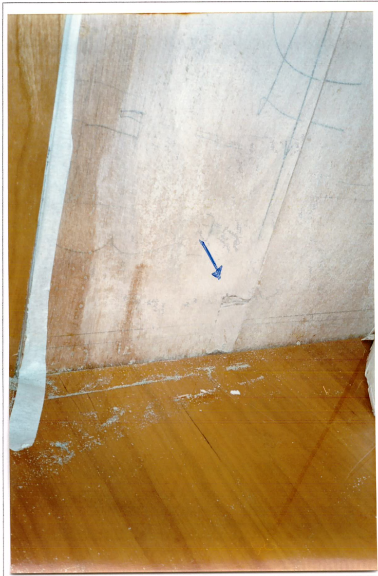
Antepara da cabine master - Rachaduras na antepara principal, por trás do revestimento. Main cabin bulkhead - cracks in the main bulkhead behind the veneer.
